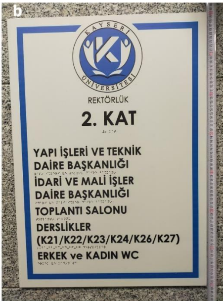
b- Duvar Bilgi Levhaları alt kısım 110 üst kısım 180 cm yükseklikte
